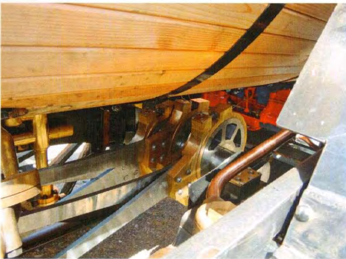
Et kig ind på excentrikerne på styringen. Foto SoB.
