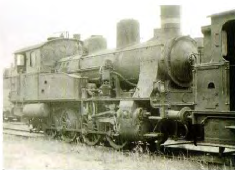
Til sammenligning DSB Q 342 den 5. juni 1966 på Københavns Godsbanegård. Taget rager ikke så langt ud. Foto K.E. Jørgensen.
