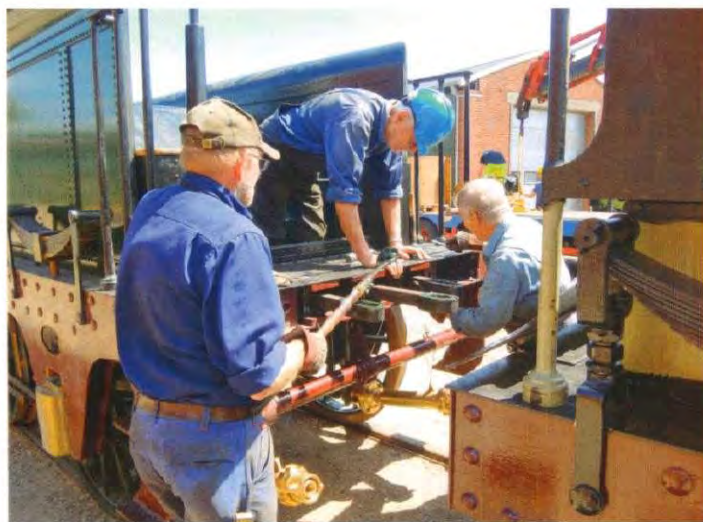
Nogle af håndværkerne fra Onsdagsholdet i færd med smøring af koblingsdelene. Foto SoB.
