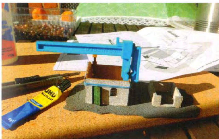
Pyh – med elastikker og skruetvinge gik det at lime ydervæggene fast på den indvendige skalmur.
