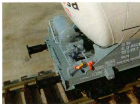
Detaljer fra undervogn med diverse haner, ventiler osv.
