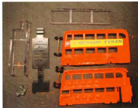
Todækkeren kan nemt skilles ad, men pas på, at rudeindsatserne ikke knækker ved processen. Indretningen består af sæderækker og en trappe.
