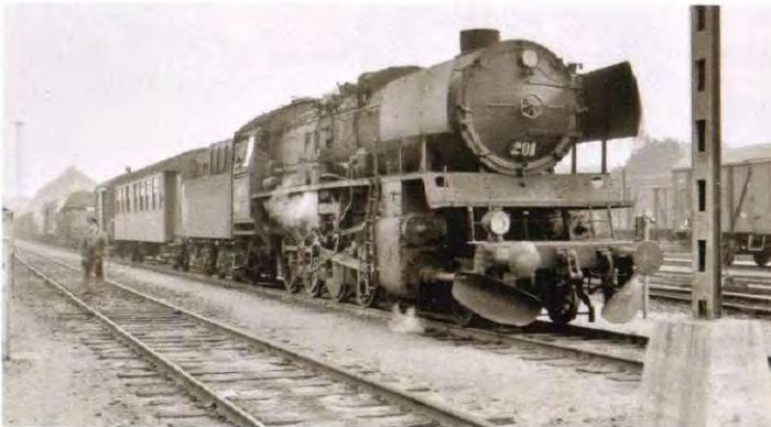
Mange af de danske ændringer kan ses her - sne- og røgskærme, 'havebænk', forlænget fodplade, røggammerdør. N 201 i Odense, ca. 1968. Foto Kaj Pedersen.
