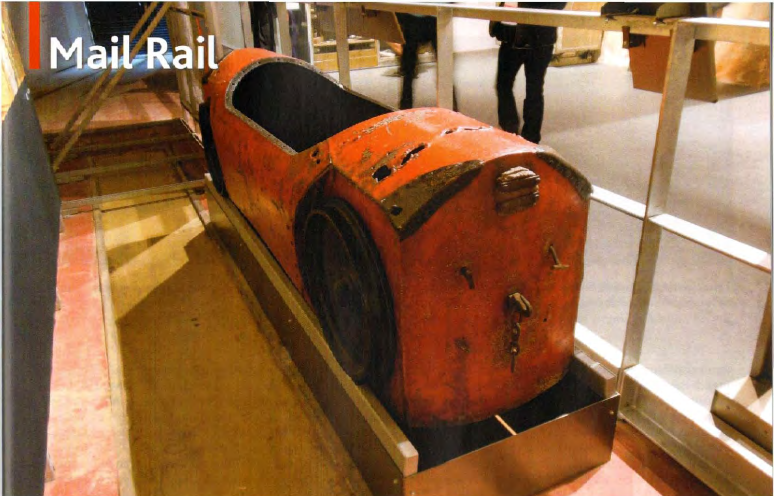
Skinnekøretøj, som blev drevet af vakuum og brugt til transport af post. Rolf Brems
