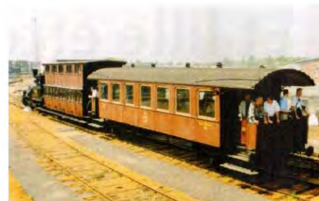
I 2000 blev den toetages Co 10498 luftet ved flere ture på Danmarks Jernbanemuseum, en rystende oplevelse. Vognen er nemlig ikke affjedret. Foto Flemming Søborg.
