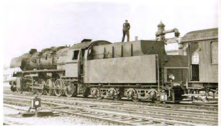
N 203 under kultagning i Silkeborg, 1958. Øjensynligt er kun forreste tenderaksel med egerhjul. Arkiv Leif Ørndorf.
