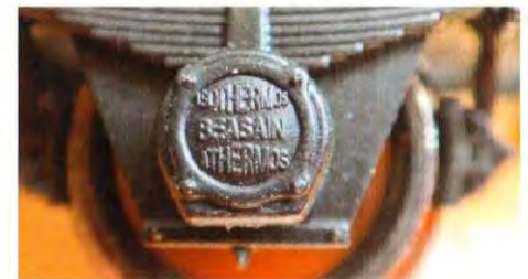
Selv akselboksene har indstøbt firmanavnet – en flot detalje.
