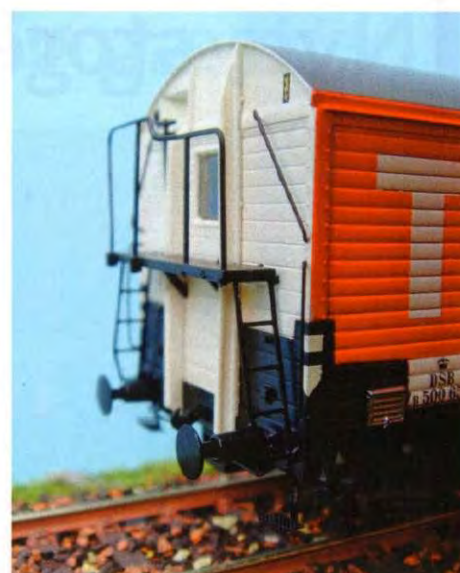
Gavlen med bremseplatform på Tuborgvognen. Foto SoB.
