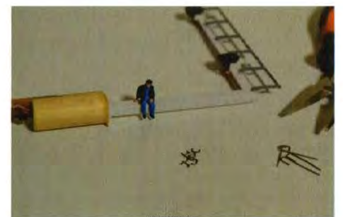
Trin bukkes af afklippet tråd fra modstande.
