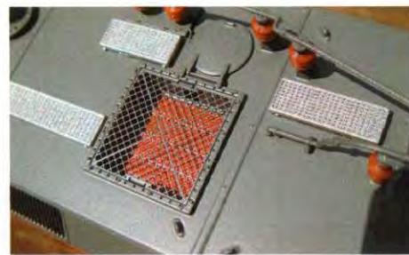
Tagdetaljer på BR 143 med fint, gennembrudt gitter.
