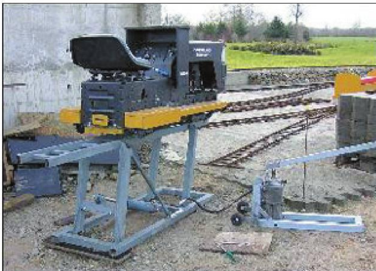
Der blev også lavet et lift, som mest bruges til servicearbejde hjemme på eget værksted.
