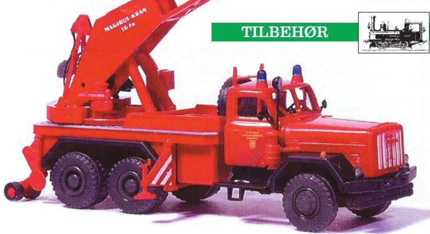
Magirus KW 16 med teleskopkran og ekstra støttehjul, der gør den egnet til indsats på stejle bjergveje.
