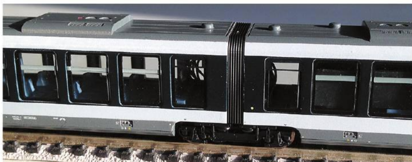
De to vogne deler en fælles Jacobs bogie.
