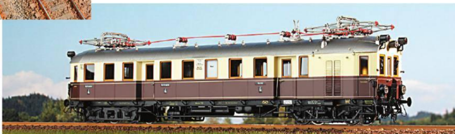
Elektromotorvogn ET 85.20 fra den bayerske gruppeforvaltning, som den så ud i 1926, efter at den blev ombygget fra en dampdrevet personvogn type MCCI.
