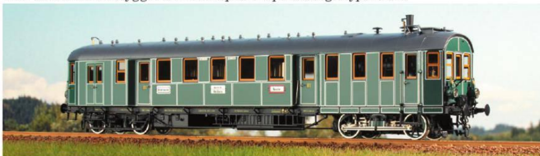
MCCI 14506 fra De kgl. bayerske Statsbaner. Sådan så den dampdrevne personvogn ud i 1913. Den var udstyret med J. A. Maffeis Turgan-maskine.
