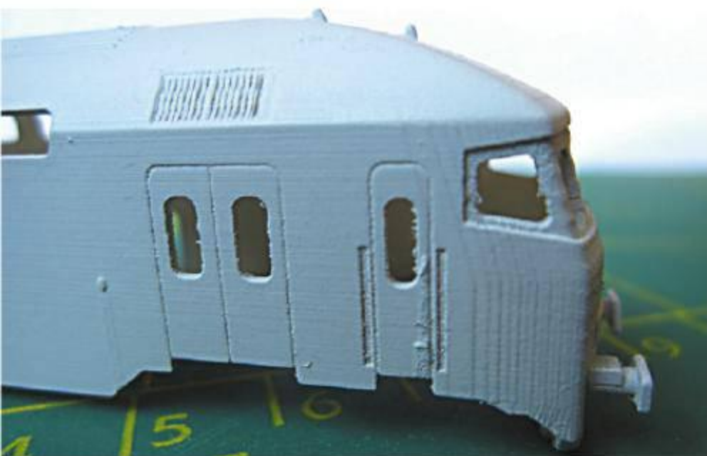
...påføres. Ujævnheder ved vinduerne kan files væk. Støbninger er i skala N.
