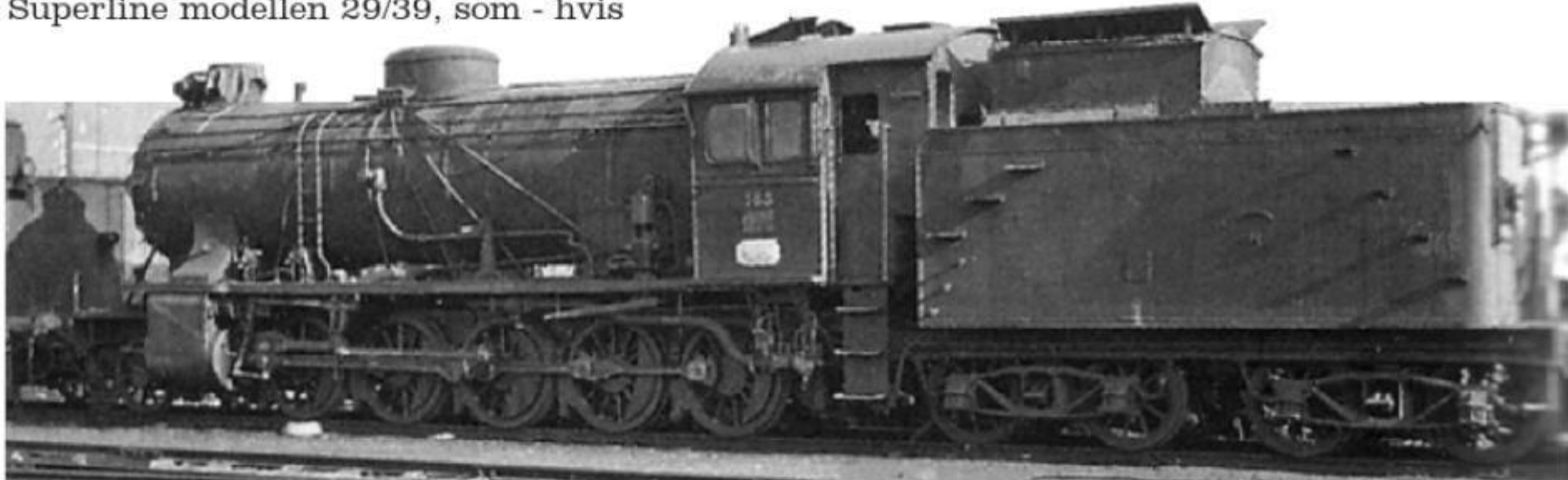
NSB type 29/39 var Norges stærkeste lokomotiv med tophastighed på 40, og senere 45 km/t. Længden var 18,25 og vægten 123,4 ton. Det var Norges svar på svenskernes R-maskine.
