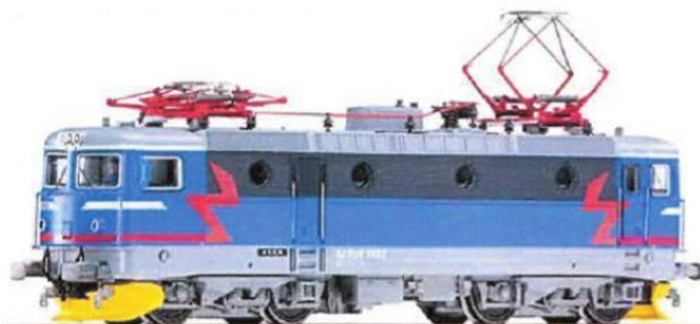
Roco: Rc6 med to forskellige pantografer og et forsøgsbemaling med rødt lyn.
