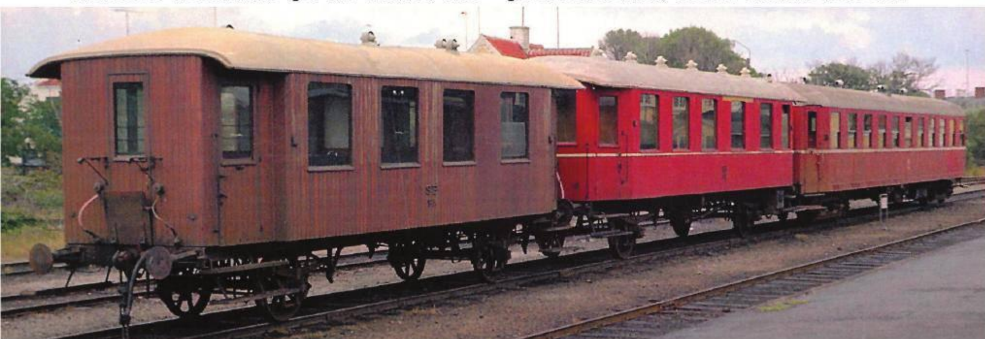
Tre slags privatbanevogne ved Skagensbanen. Fra venstre motorbivogn F 1 fra 1927, sidegangsvogn B 11 fra 1924 og senere moderniseret med lukkede endeperroner og til sidst stålvogn F 4 fra 1937. Skagen 1966. FOTO: LVN.
