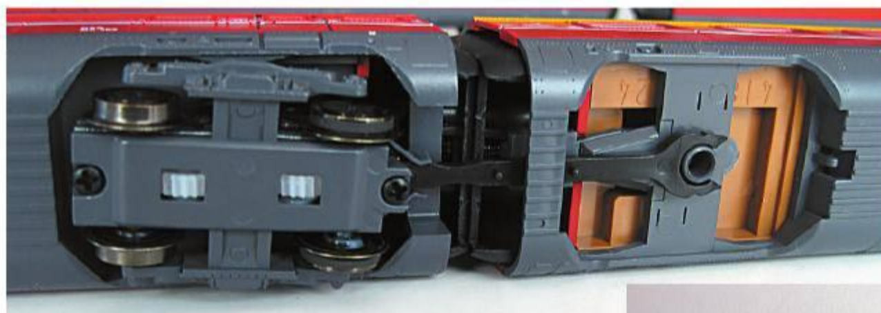
Man fjerner bogien, sætter koblingsstangen på og stikker bogien på plads igen. Så enkelt er det...
