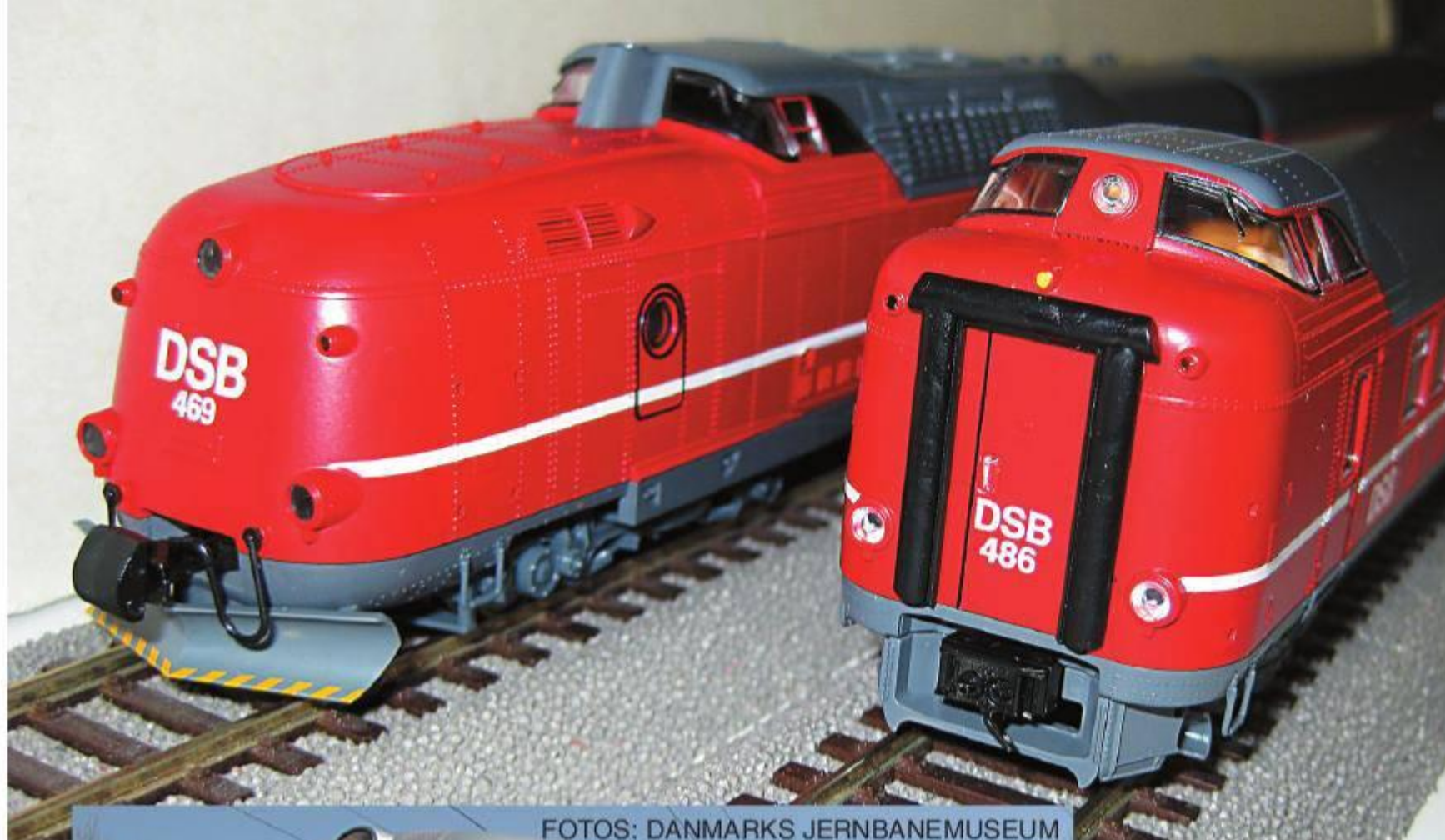
Motorvogn MA 469 og styrevogn BS 486 med Scharfenberg-kobling-dummy.
