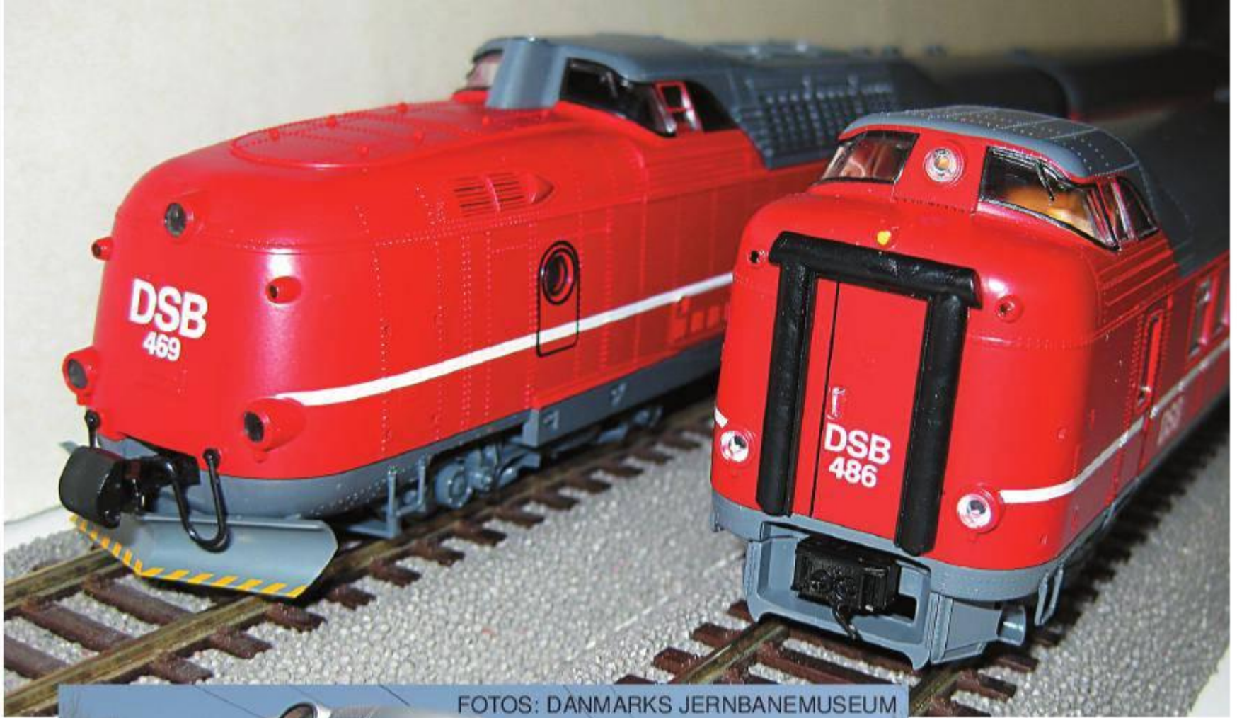
Motorvogn MA 469 og styrevogn BS 486 med Scharfenberg-kobling-dummy.
