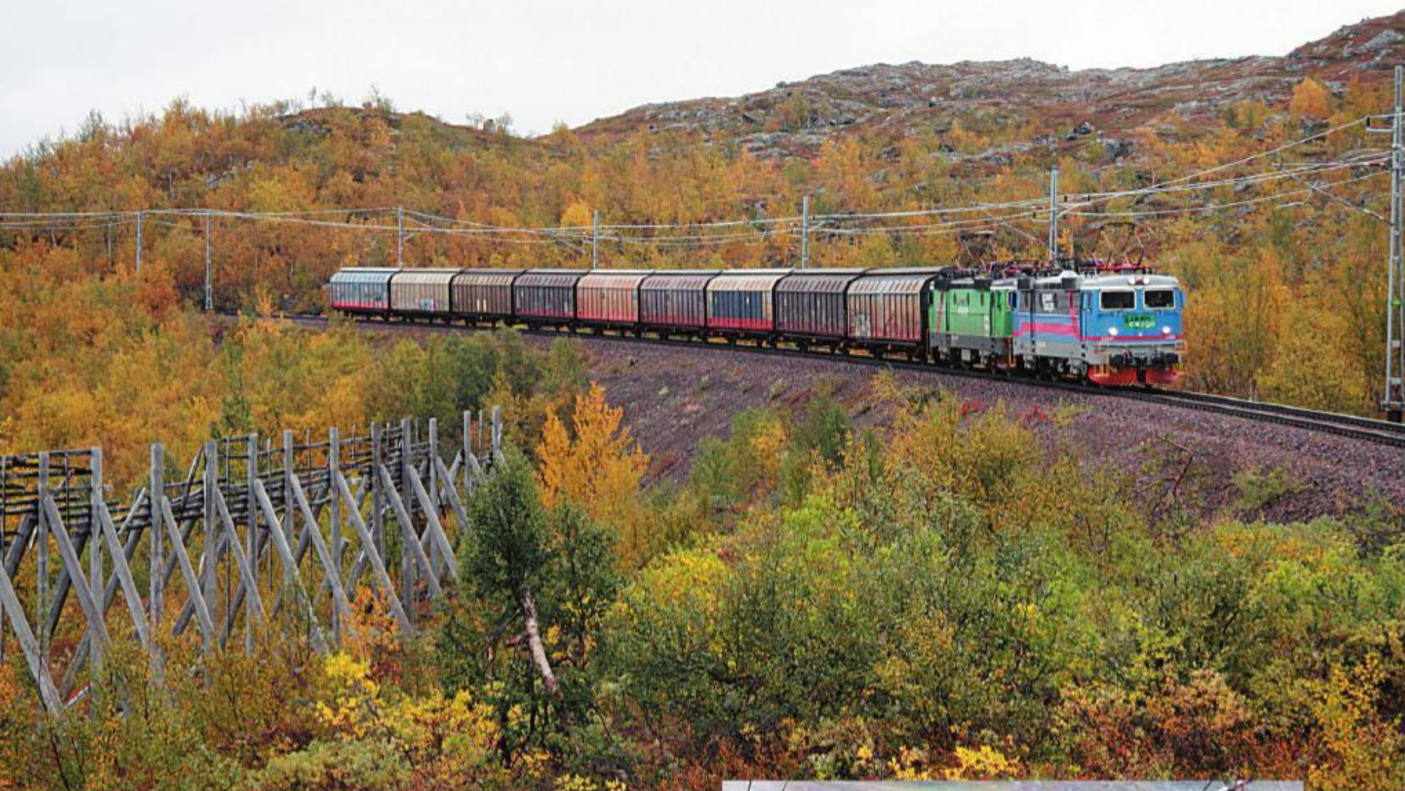
Et Green Cargo godstog med kun ni toakslede Hbis-vogne trukket af to Rc-lokomotiver.
