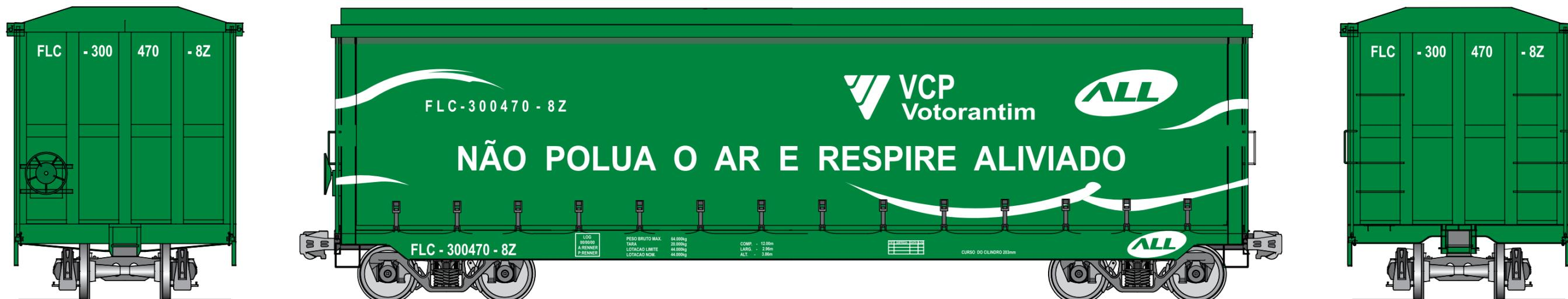
Os vagões do tipo "sider", com fechamento das laterais através de lonas, foram desenvolvidos há alguns anos para a ALL e MRS, através de uma empresa especializada nesse tipo de solução para carretas rodoviárias. O objetivo era substituir as portas metálicas dos vagões que transportam celulose até o Porto de Santos.
